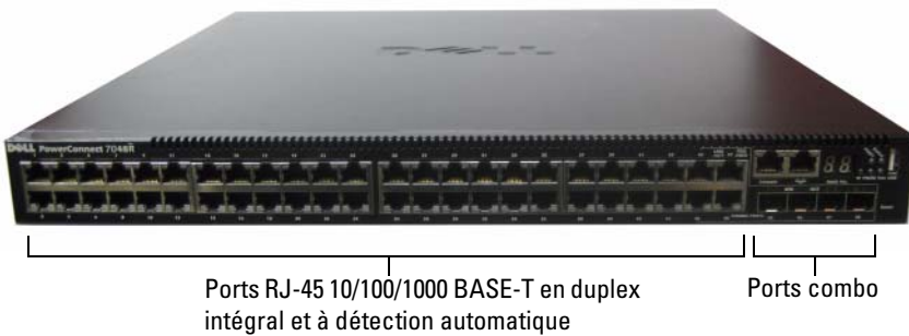
Figure 1-6. PowerConnect 7048R avec 48 ports 10/100/1000 BASE-T
