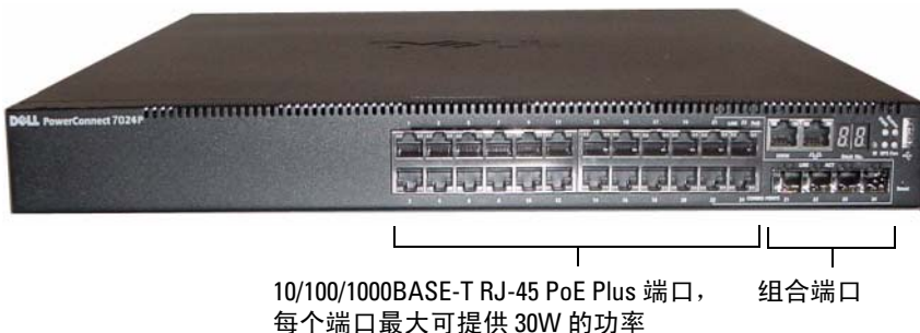
图 1-2. PowerConnect 7024P, 具有 24 个 10/100/1000BASE-T PoE Plus 端口
